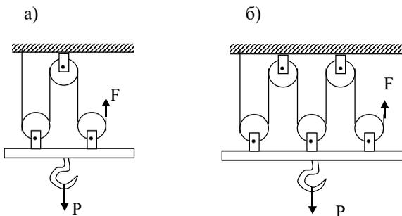
Один подвижный блок дает выигрыш в силе в 2 раза, следовательно, комбинация 2-ух подвижных и неподвижного блока даст выигрыш в силе в 4 раза, а 2-ух неподвижных и 3-ех подвижных в 6 раз.
