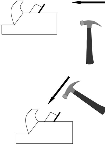
При ударе по железке она входит в рубанок, так как на нее действует молоток, при ударе по колодке железка выходит из рубанка, так как рубанок начинает двигаться под действием молотка, а железка под действием инерции стремится оставаться в покое.
